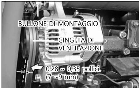
Controllare e regolare periodicamente la tensione della cinghia della ventola.
