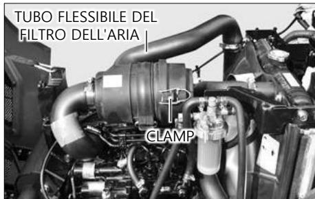
Controllare il tubo del filtro dell'aria come segue :
