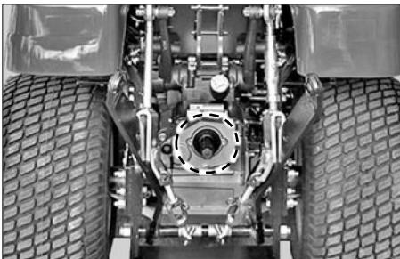
Il trattore è dotato di una presa di forza a una velocità (540 giri/min). Utilizzare la leva della PTO per innestarla. L'interruttore della PTO deve essere spento prima che la PTO venga innestata.
