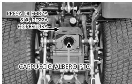
Quando l'albero della presa di forza non viene utilizzato, ingassare l'albero della presa di forza e installare il tappo.
