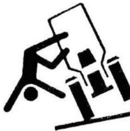
La struttura di protezione antiribaltamento (ROPS) è stata certificata secondo gli standard industriali e/o governativi. Qualsiasi danno o alterazione al ROPS, alla ferramenta di montaggio o alla cintura di sicurezza invalida la certificazione e riduce o elimina la protezione dell'operatore in caso di ribaltamento.
